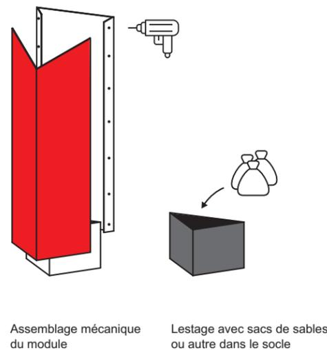
Assemblage mécanique du module
