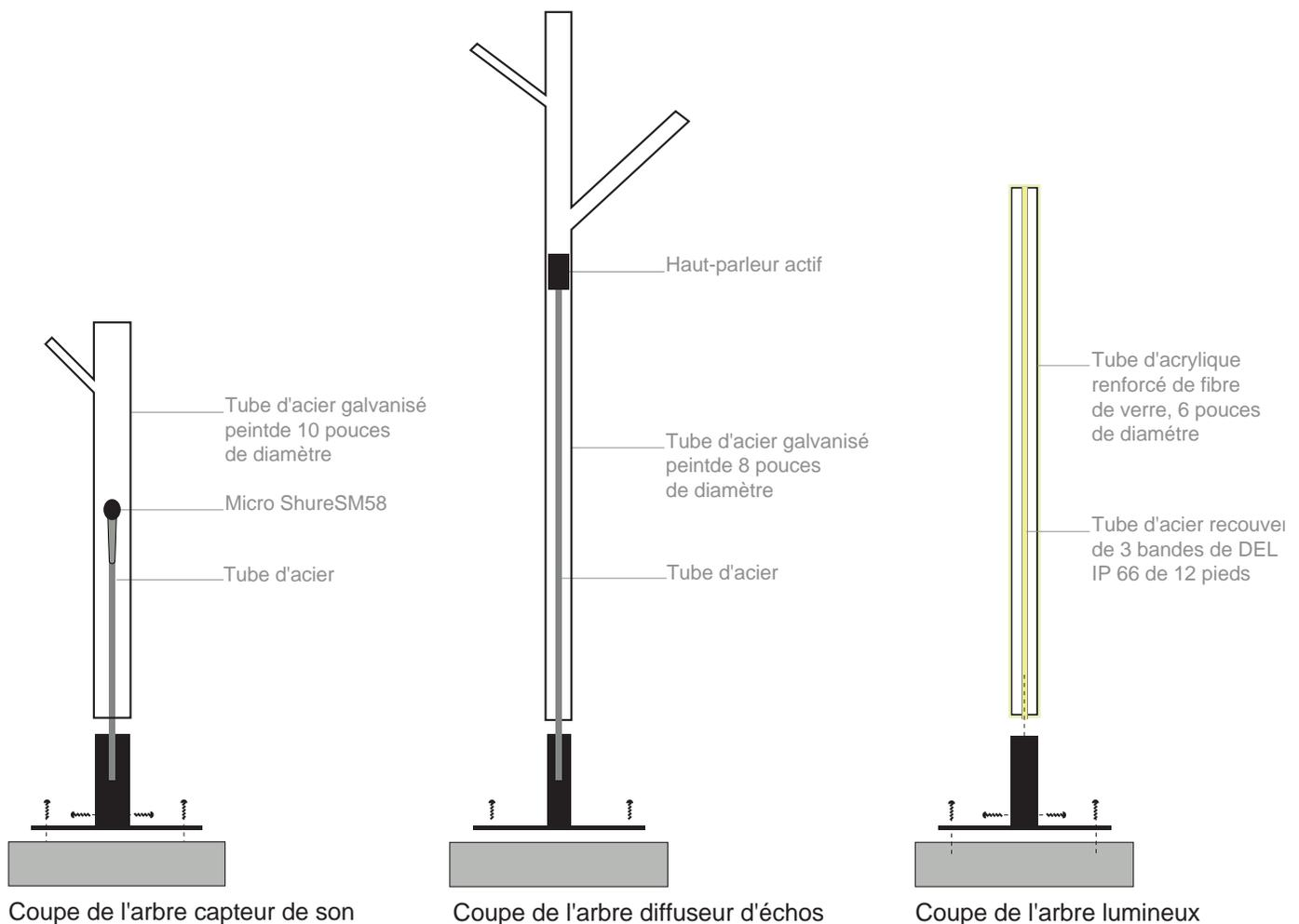
Au centre du *Betula Luminosus*, un tuyau d'acier est recouvert de 3 bandes autocollantes (12') de diodes électroluminescentes (DEL) de norme IP66 (résistance au froid et à l'humidité). Ces DEL diffusent une lumière blanche intense et permettent une gradation lumineuse précise. Elles consomment très peu d'énergie (à pleine capacité, la forêt ne consomme que 3kW)
