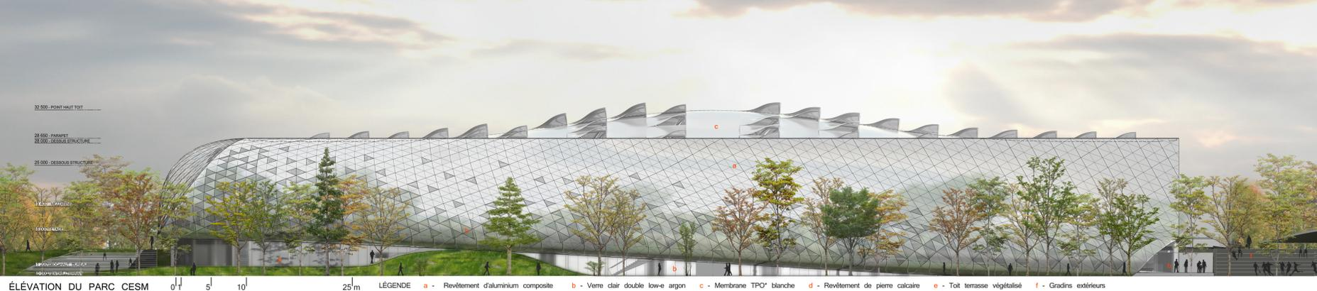
ÉLEVATION DU PARC CSM 0' 5' 10' 25m LÉGENDE a - Revêtement d'aluminium composite b - Verre clair double low-e argon c - Membrane TPO\* blanche d - Revêtement de pierre calcaire e - Toit terrasse végétalisé f - Gradins extérieurs
