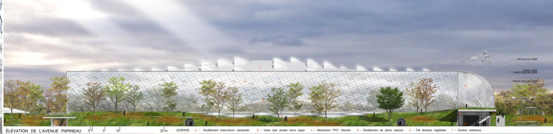
ÉLEVATION DE L'AVENUE PAPINEAU 0' 5' 10' 25m LÉGENDE a - Revêtement d'aluminium composite b - Verre clair double low-e argon c - Membrane TPO\* blanche d - Revêtement de pierre calcaire e - Toit terrasse végétalisé f - Gradins extérieurs
