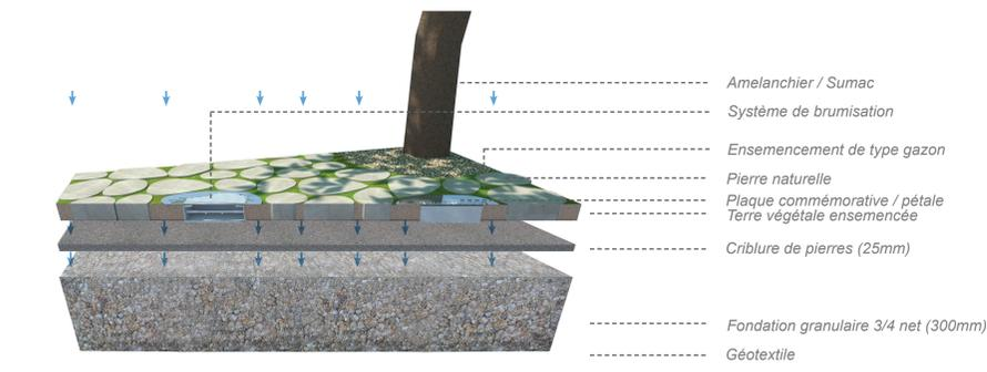
schéma d'infiltration - 1/10
