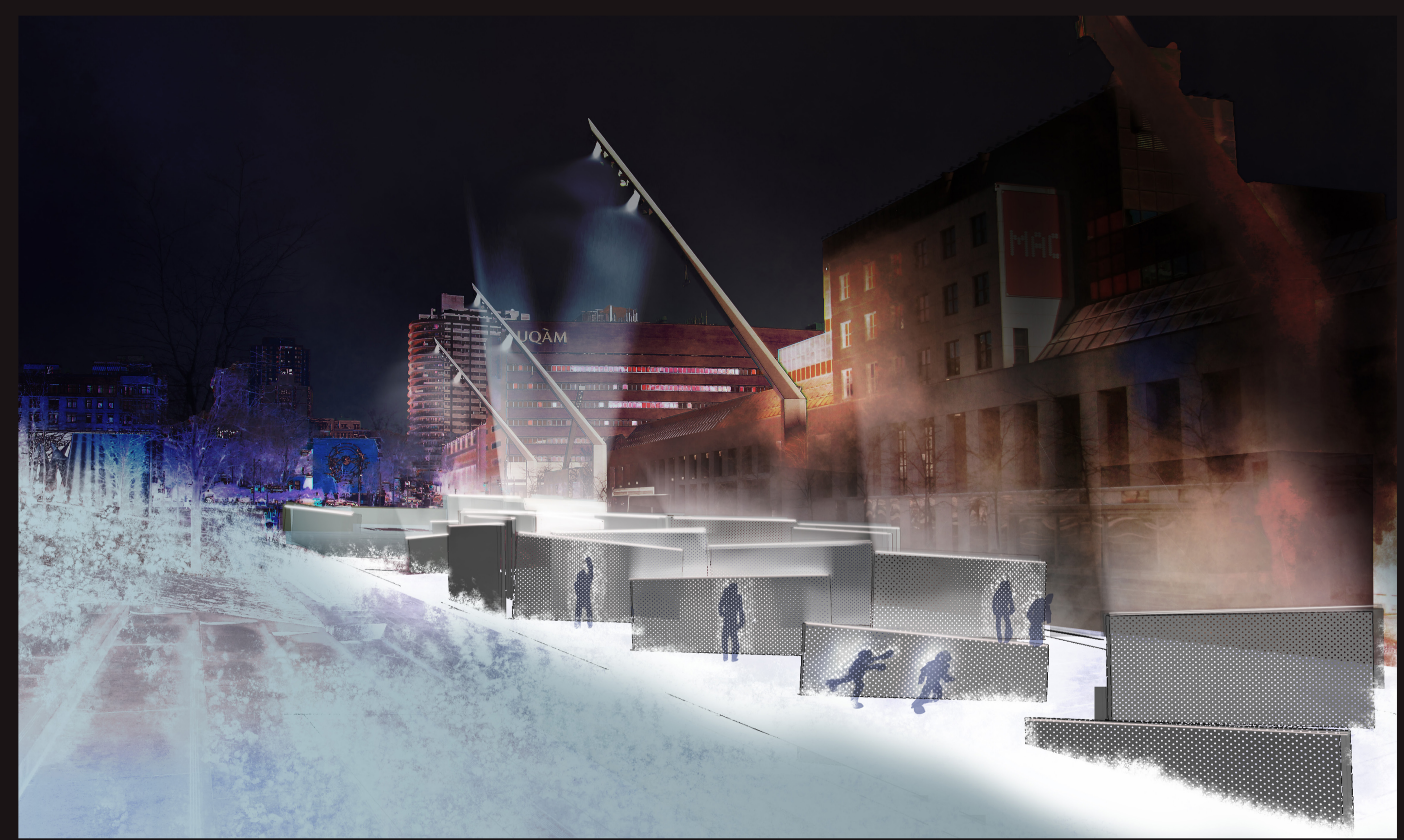
PAROI DE TYPE A Double épaisseur de panneaux métalliques perforés - trous de 1/4" à 3/4" suivant implantation de la paroi. INTERACTION: visuel à travers perforations. SYSTÈME LUMINEUX: Lumière se diffusant depuis le haut de la paroi.
