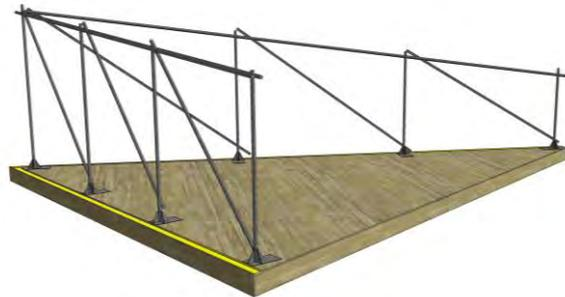
Un réseau de tuyaux stratégiquement perforés est fixé au haut de cette structure et laisse s'échapper de l'eau que le gel transformera en glaçons, puis en véritable parois de glace. Une fois la glace solidifiée à sa hauteur maximale, l'installation prend forme et devient semi-opaque.
