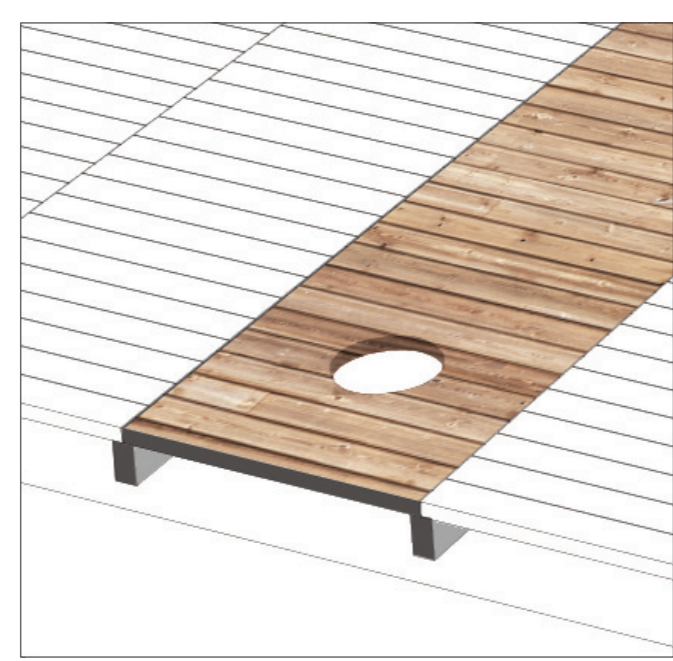
Détail, platelage de bois Le quai est composé d'un platelage de bois en sapin Douglas (BCF) de type madrier 3" x 8" supporté par une structure de bois (solive) et d'acier (poutre).
