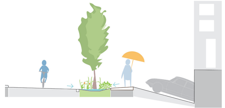
Une rue de largeur réduite et une noue
