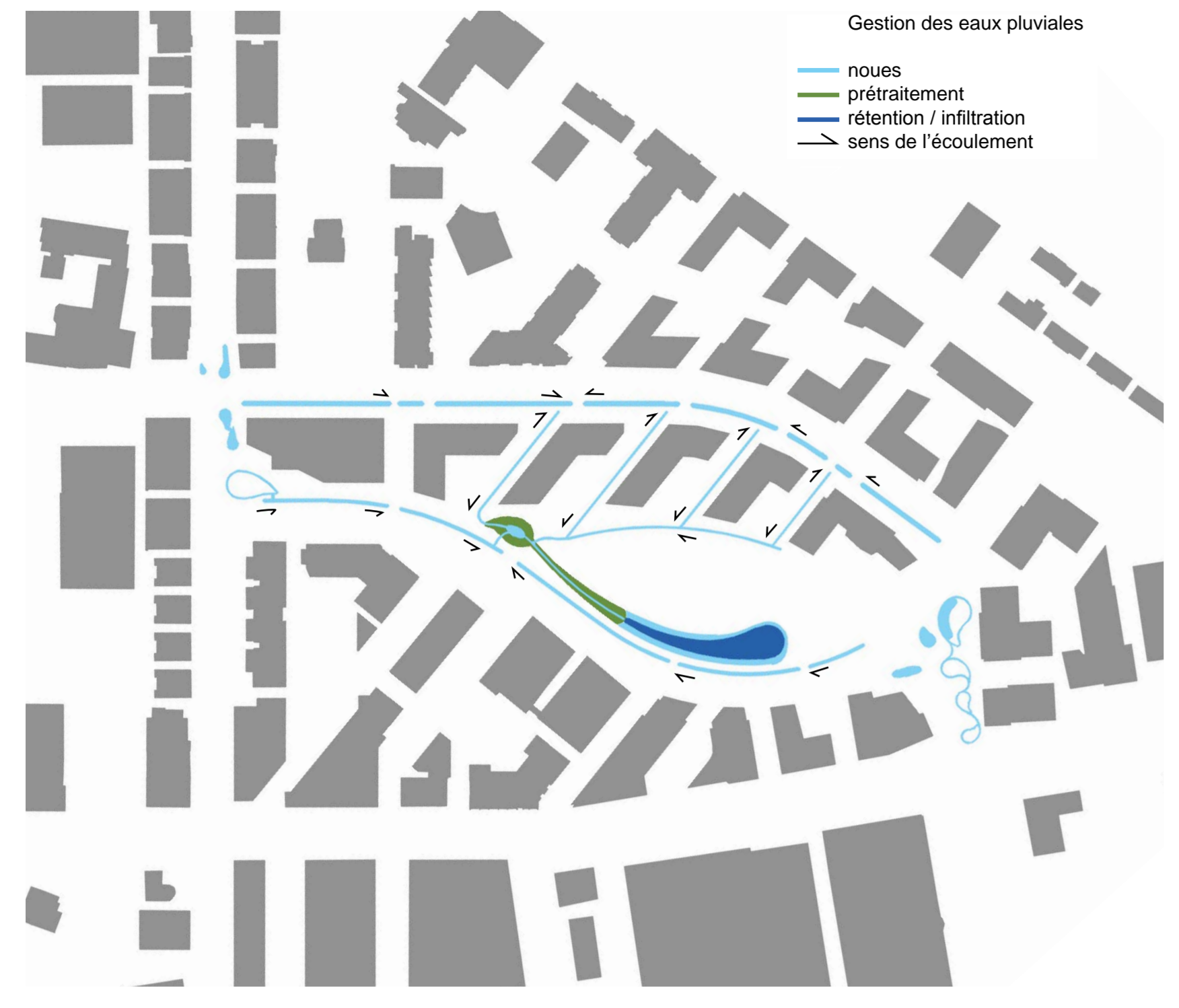
Plan de la gestion des eaux pluviales 1:3000
