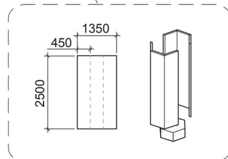
Construction simple, résistante et légère : 2 feuilles d'aluminium pliées, soudées, puis assemblées sur un bloc de béton
