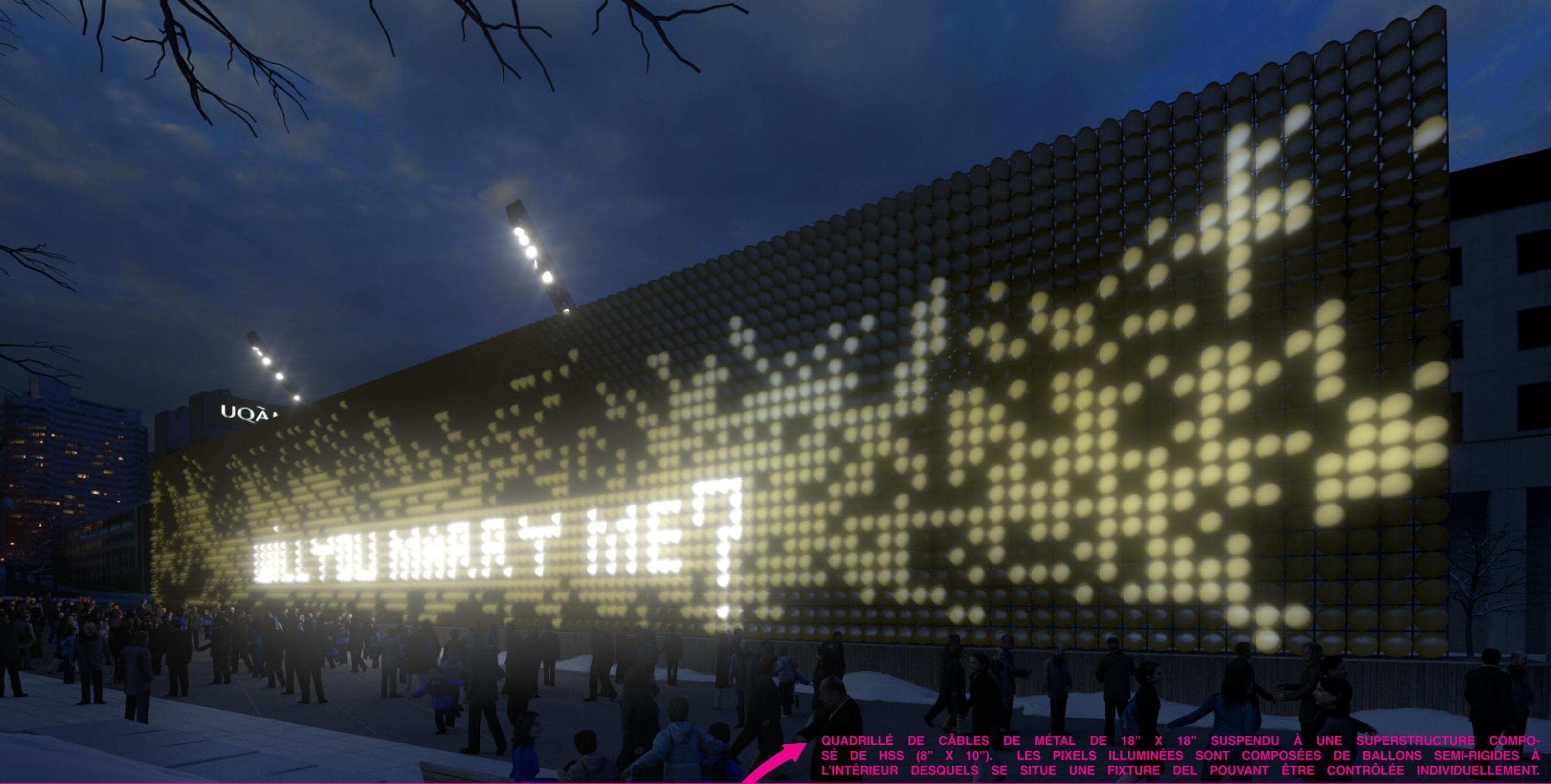
QUADRILLÉ DE CÂBLES DE MÉTAL DE 18" X 18" SUSPENDU À UNE SUPERSTRUCTURE COMPOSÉ DE HSS (8" X 10"). LES PIXELS ILLUMINÉES SONT COMPOSÉES DE BALLONS SEMI-RIGIDES À L'INTÉRIEUR DESQUELS SE SITUE UNE FIXTURE DEL POUVANT ÊTRE CONTRÔLÉE INDIVIDUELLEMENT.
