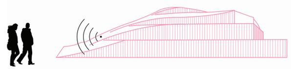
Des capteurs disposés à plusieurs endroits dans les strates des îlots permettront aux noctambules de faire réagir la lumière grâce à un simple mouvement de passage à proximité de la structure.
