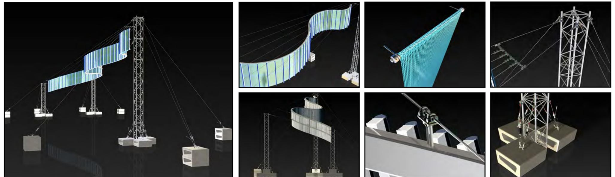
ÉLÉMENTS STANDARDS DE L'INDUSTRIE LESTÉS D'APRÈS DES CALCULS D'INGÉNIERIE ET RAIL D'ACCROCHAGE DE LUMINAIRES FABRIQUÉ SUR MESURE. TISSU À MAILLAGE AÉRÉ. RÉSEAU DE CÂBLES AÉRIEN ASSEMBLÉ EN ATELIER.
