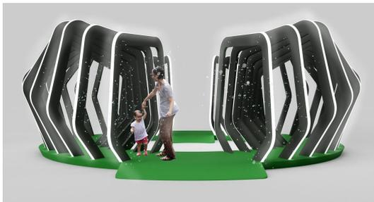
Pour se rafraîchir, des modules reconfigurables guideront les gens à travers un parcours ponctué d'une bruine fraîche. Soit amalgamé en cercle ou soit en serpent, le parcours légèrement surélevé sera accessible par une rampe d'accès. Munie d'une surface antidérapante, la base de l'installation renfermera le système de tuyauterie qui permettra son bon fonctionnement. Comme nous optons pour l'utilisation de
