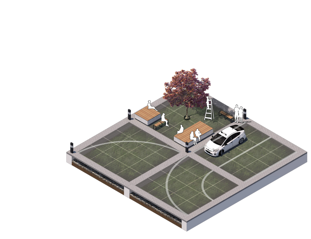
UNE VOIE CARROSSABLE PASSIVE L'accès au stationnement du Centre Eaton est une partie intégrale de la stratégie durable de la gestion des eaux grâce à son pavé de grillage métallique sous lequel une végétation sauvage sort efficacement captées les eaux de pluies.
