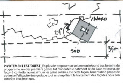
**PIVOTEMENT EST/OUEST** En plus de proposer un volume qui répond aux besoins du programme, un des premiers gestes fut d'orienter le bâtiment selon l'axe est-ouest, de façon à contrôler au maximum les gains solaires. De cette façon, l'orientation proposée optimise l'efficacité énergétique tout en simplifiant le traitement des façades pour son contrôle bioclimatique.
