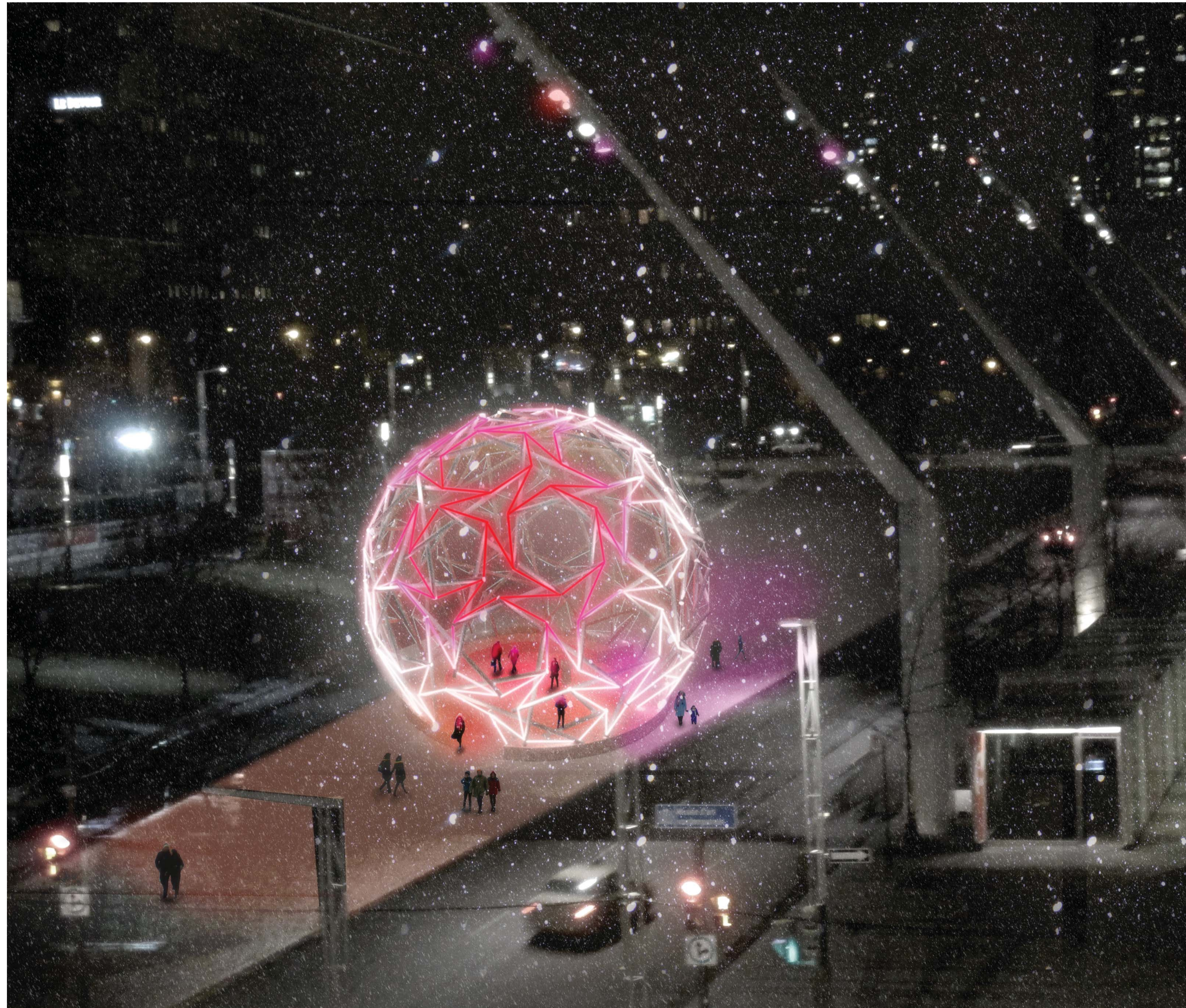
De nuit la perception s'inverse. Des fils LED interactifs sont associés aux câbles et des capteurs détectent le passage du vent à travers la structure. Là où le vent souffle, les LED changent de couleur, comme si on soufflait sur un tison.
