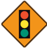
T-D-50-1 Signal avancé de feux de circulation
